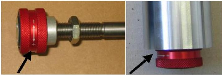
Die Dämpfkraft kann OHNE Werkzeug per Hand im eingebauten Zustand verstellt werden! Beim Verstellen muss das Einrasten auf den verschiedenen Positionen mit einem „Klick“ deutlich spürbar sein. Kraftverstellung:
